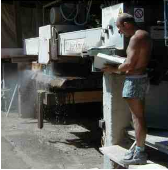
Zusägen der Platte auf die vorgegebenen Maße
