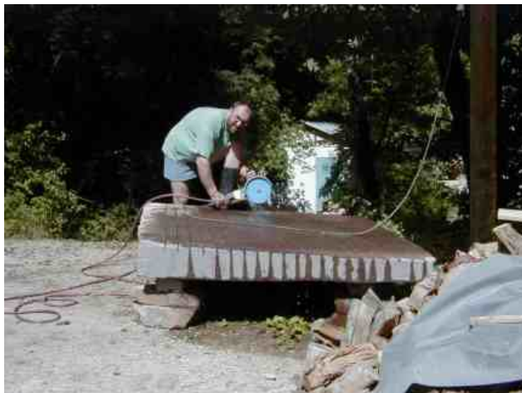
Schneiden der 2cm tiefen karoförmigen Schnitte
