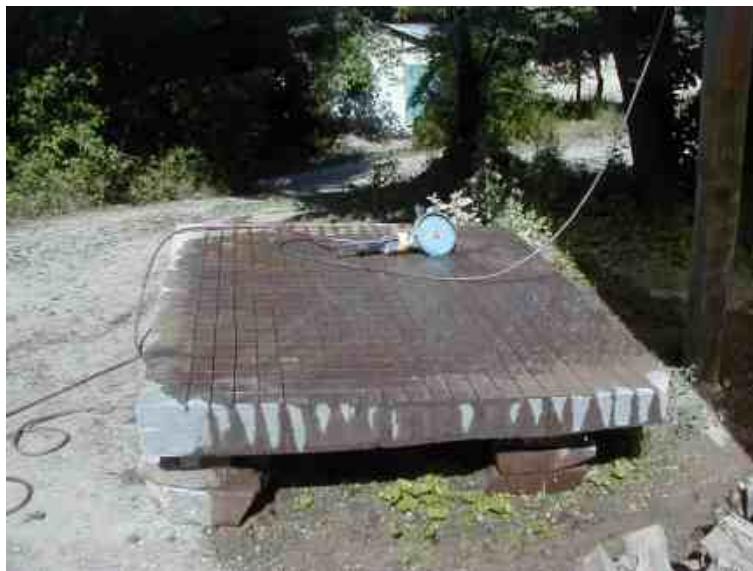
Schneiden der 2cm tiefen karoförmigen Schnitte
